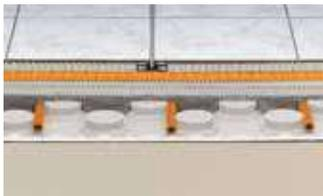
Panneaux de polystyrène expansé rigides offrant une isolation intégrée
